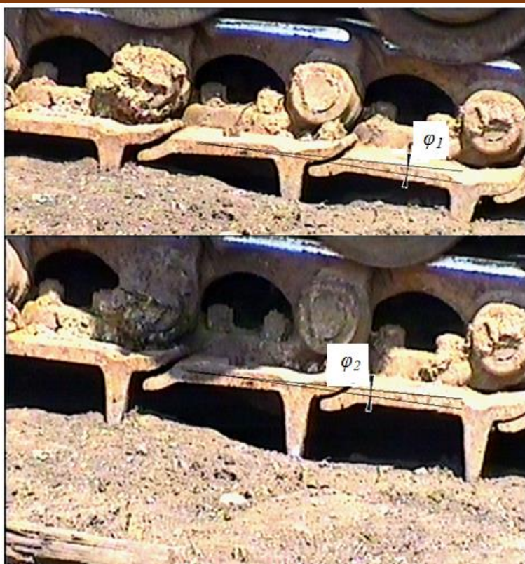
Рисунок 4 – Пример определения относительного угла поворота траков [5]
